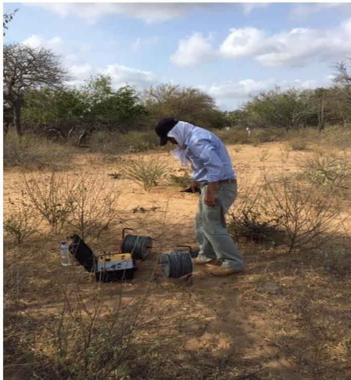
Foto 4. Ejecución de exploraciones geoelectricas en la zona enmarcada para construcción de tanque.
