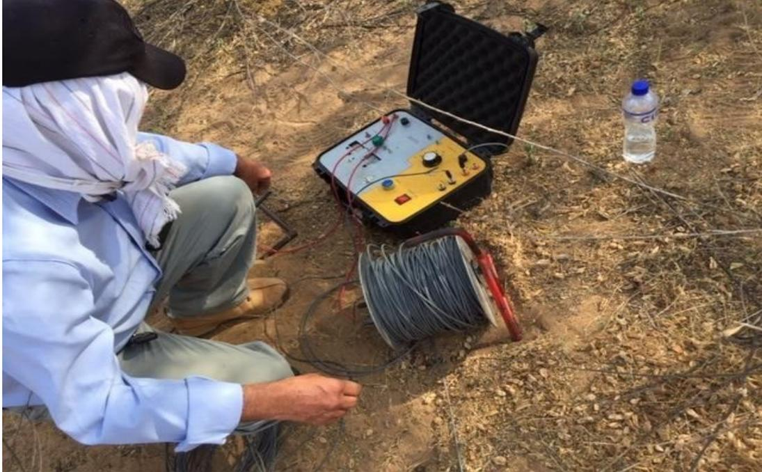
Foto 3. Ejecución de exploraciones geoelectricas en la zona enmarcada para construcción de tanque.
