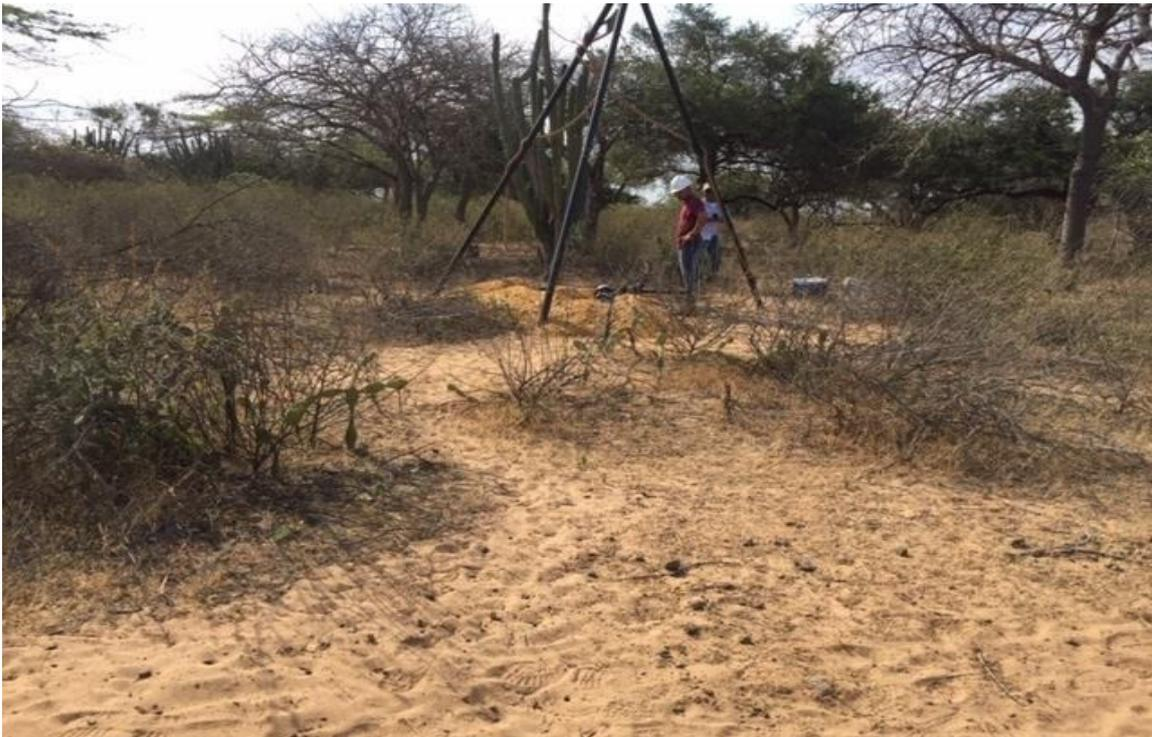
Foto 1. Sondeos realizados en campo para la caracterización del terreno.
