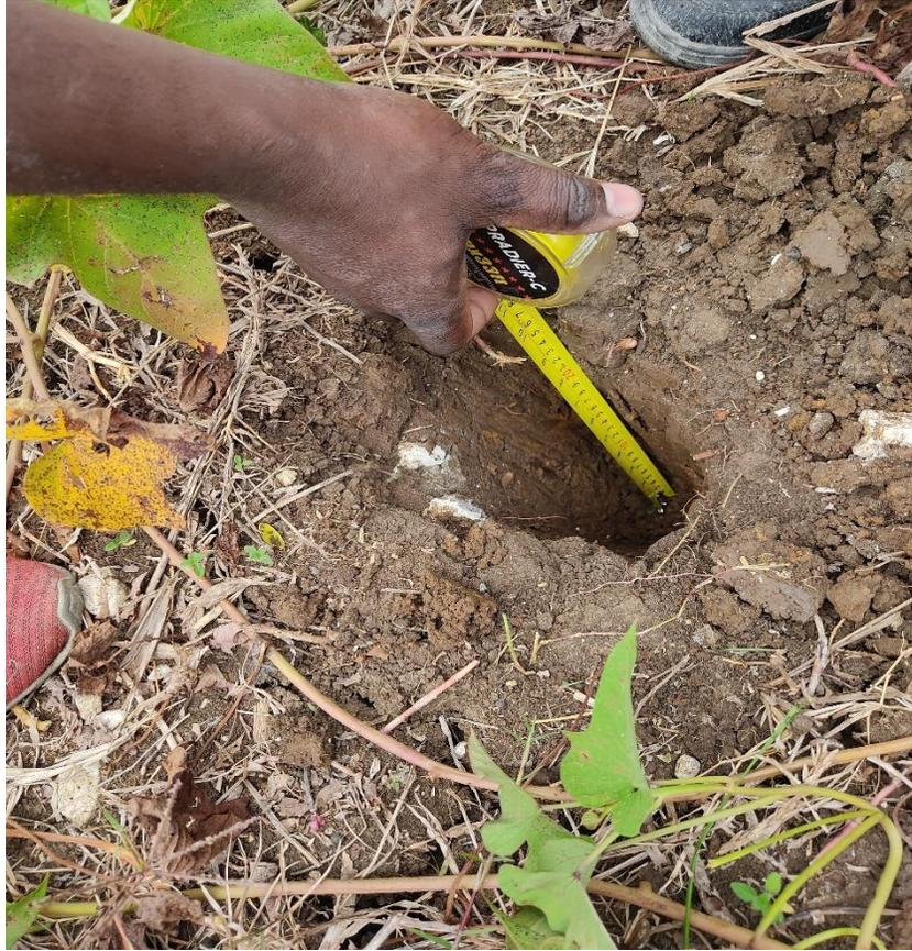
*Image 12: Mesure de la profondeur du profil*
